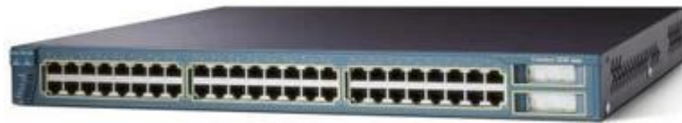
Рисунок 3.2 –Комутатор Cisco WS-C3550-48-EMI
