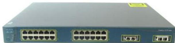
Рисунок 3.3 –Комутатор Cisco Catalyst WS-C3550-24
