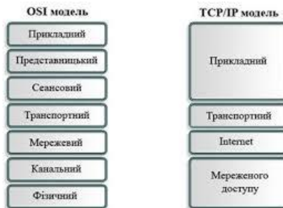
Рисунок 1.6 – Порівняння рівнів TCP/IP і ISO/OSI
