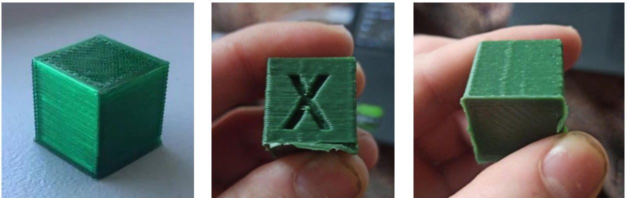
Рисунок 4.2 – Результат друку тестових моделей за допомогою ABS
