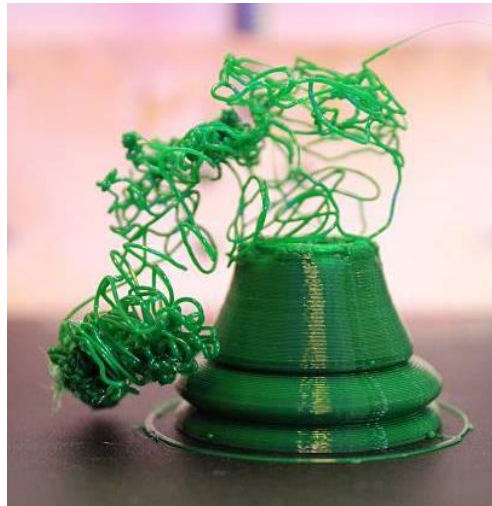
Рисунок 4.3 – Результат друку тестової моделі за допомогою PETG пластику з недотриманням температурного режиму
