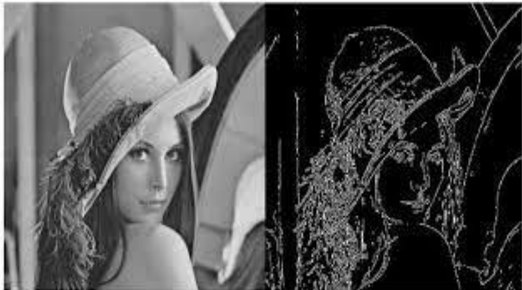
Рисунок 1.5 – Приклад алгоритму виділення країв
