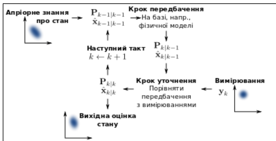
Рисунок 2.4 – Алгоритм фільтра Калмана [19]
