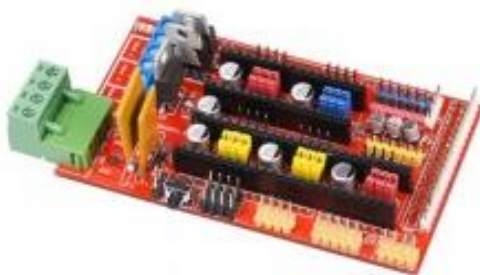
Рисунок 2.28 – RAMPS 1.4, плата розширення
