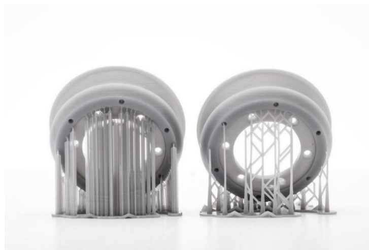
Рисунок 1.12 – Приклади опорних конструкцій після 3D-друку
