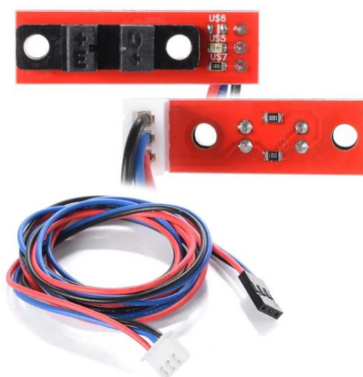
Рисунок 2.24 – Кінцевий вимикач оптичний, EndStop
