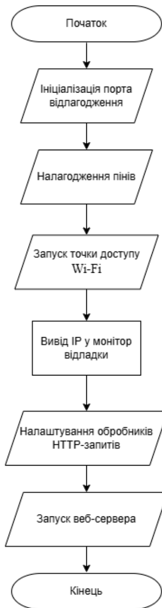
Рисунок 3.36 – Блок-схема алгоритму роботи функції setup
