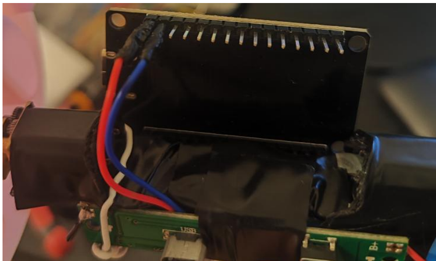
Рисунок 3.27 – Кріплення ESP32 та живлення
