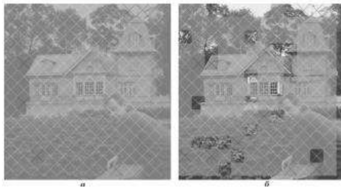
Рисунок 4.7 – Збереження маркування в растровому зображенні, збереженому в форматі JPEG з різними коефіцієнтами якості
