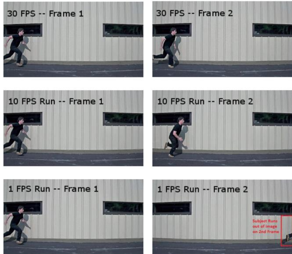
Рисунок 1.4 – Залежність положення людини під час бігу від частоти кадрів, перший кадр (зліва) та другий кадр (справа)
