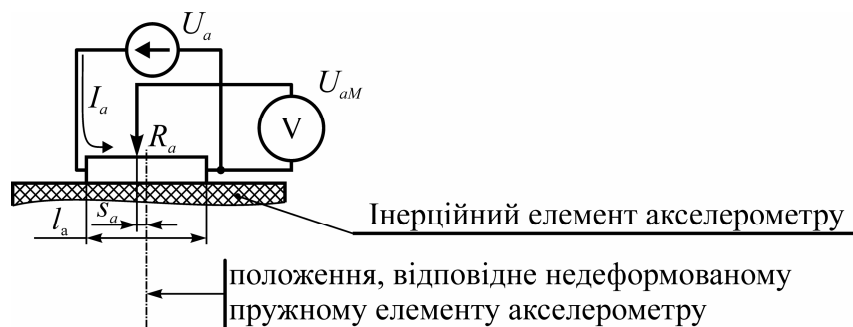
Рисунок 4 – Еквівалентна електрична схема вимірювальної частини акселерометру
