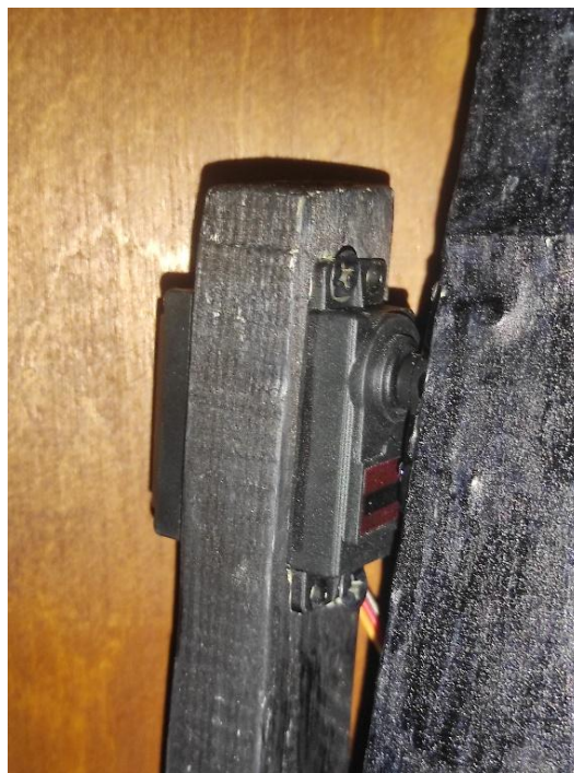
Рисунок 3.9 – Отвір для утримання сервоприводу
