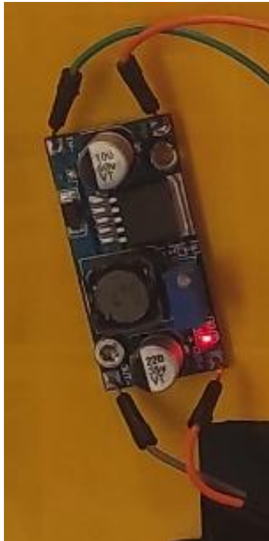
Рисунок 3.25 – Реакція LM2596 на живлення від сонячних панелей
