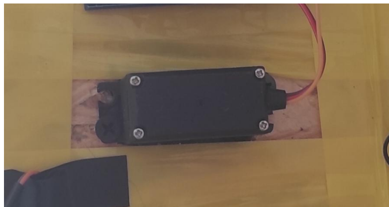
Рисунок 3.16 – Метод закріплення обертаючої платформи на основній поверхні
