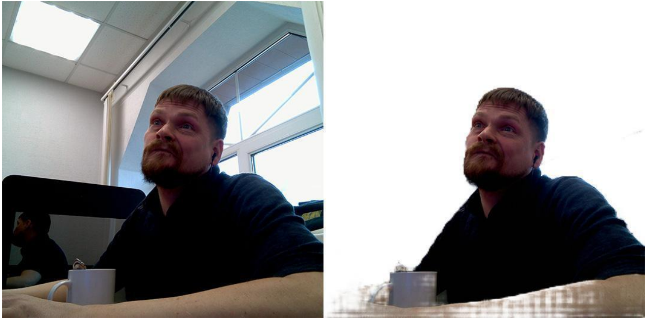
Рисунок 2.4 – Видалення фону одиничного об'єкта з задовільним результатом
