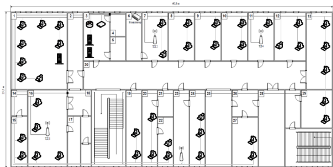
Рисунок 4.10 – Місця розміщення мережевого обладнання
