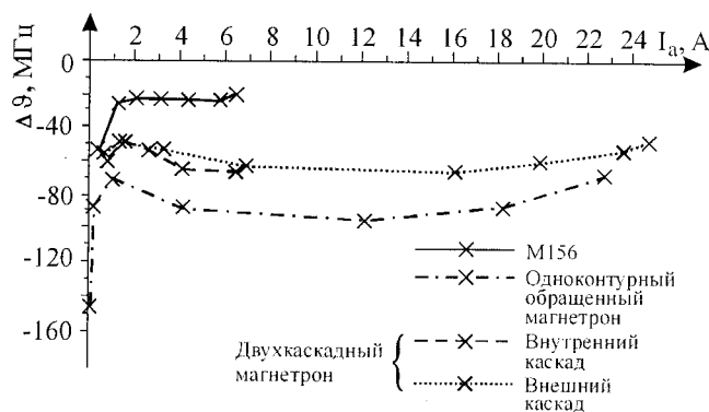
Рис. 15. Кривые электронного смещения частоты двухкаскадного магнетронного автогенератора (М156+обращенный магнетрон)
