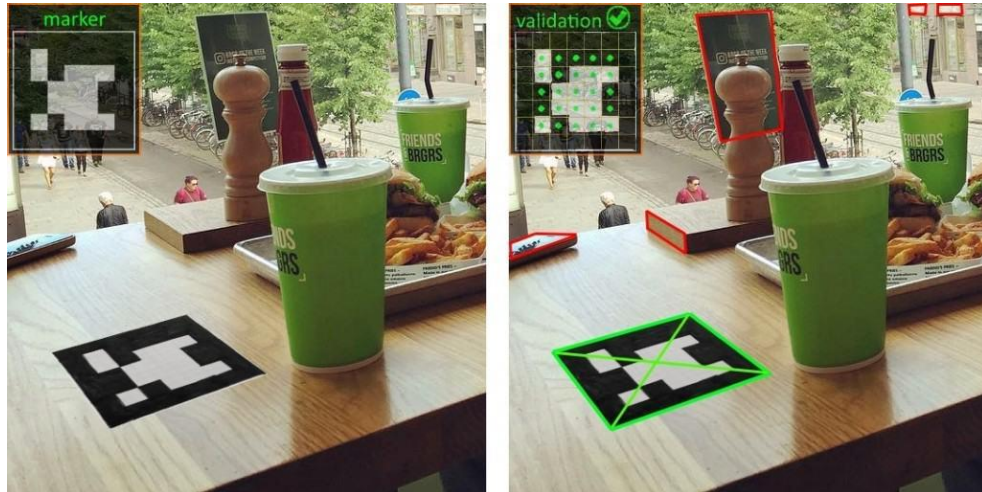
Рисунок 2.3 – Сцена з бінарним маркером (ліворуч) та виявленим маркером (праворуч)
