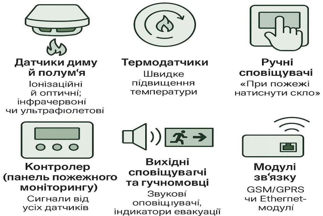
Рисунок 1.2 – Основні компоненти систем пожежної сигналізації
