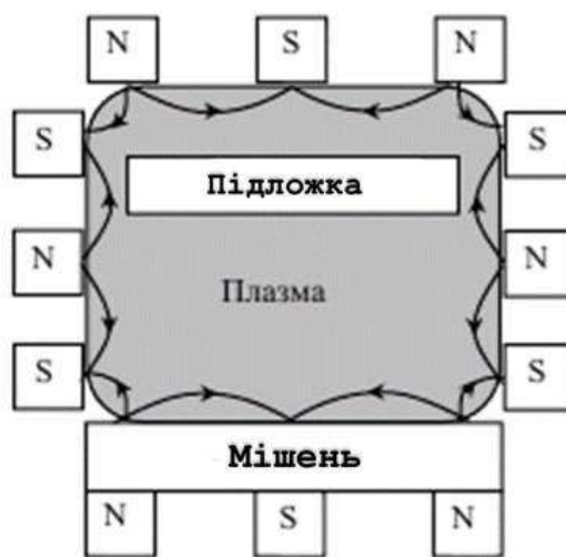
Рисунок 2.4 - MPC із магнітною ізоляцією стінок вакуумної камери
