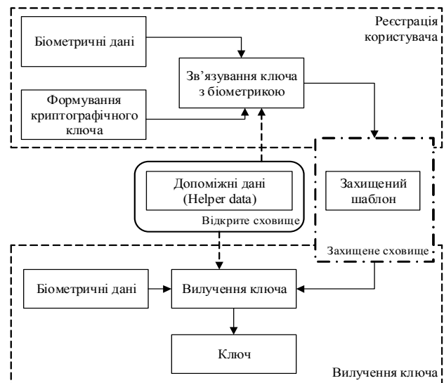
Рис. 3. Схематичне зображення біометричної криптографічної системи зі зв'язуванням ключа
