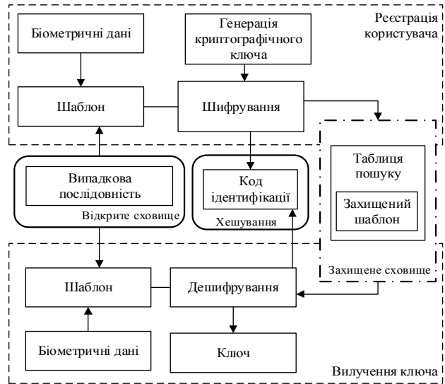
Рис. 4. Схематичне зображення біометричної криптографічної системи зі зв'язуванням ключа: біометричне шифрування
