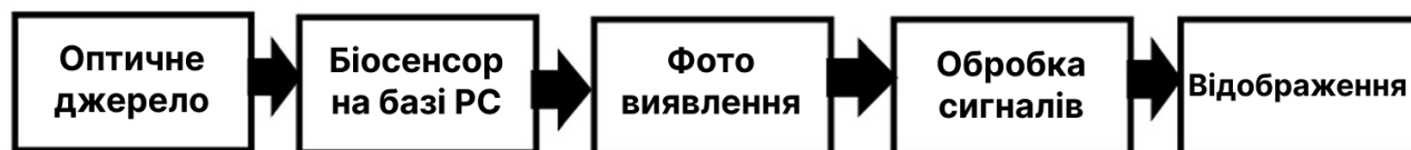
Рисунок 1.2 – Схематичне зображення оптичної вимірювальної системи.
