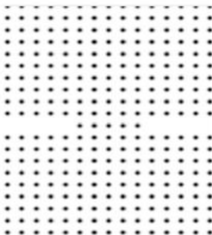
Рисунок 1.5 – Фотонно-кристалічна структура біосенсора.
