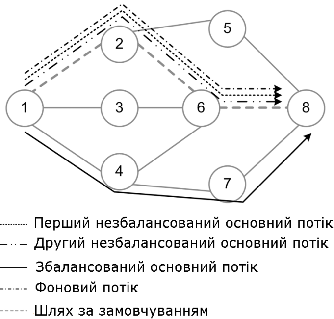
Рисунок 4.14 – Перемикання одного з основних потоків на шлях 1-4-7-8 з використанням механізму Сета
