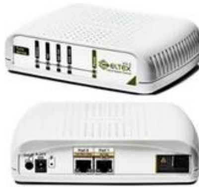
Рисунок 2.5 – Абонентський термінал NTP-2
