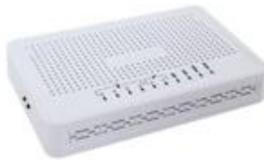
Рисунок 2.6 – Абонентський термінал NTP-RG-1402G-W
