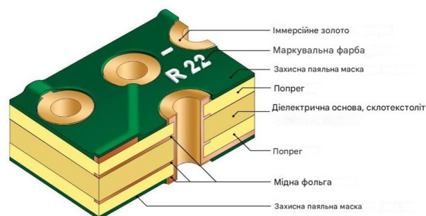
Рисунок 1.11 – Шари багатошарової друкованої плати
