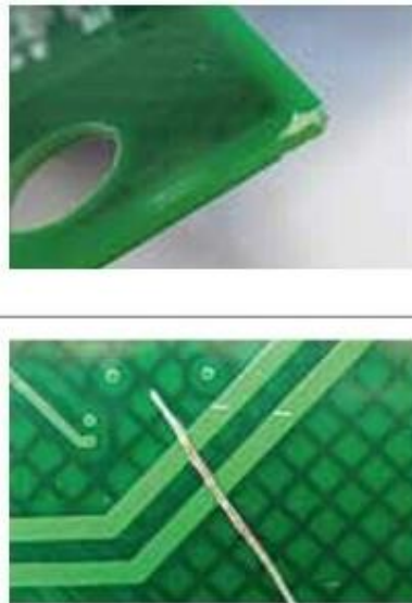
Рисунок 1.21 – Приклад механічних пошкоджень
