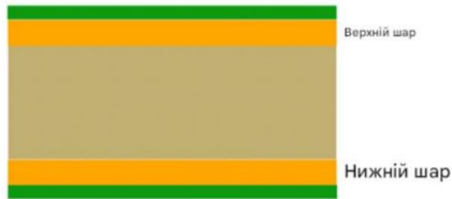
Рисунок 1.3 – Двошарова друкована плата
