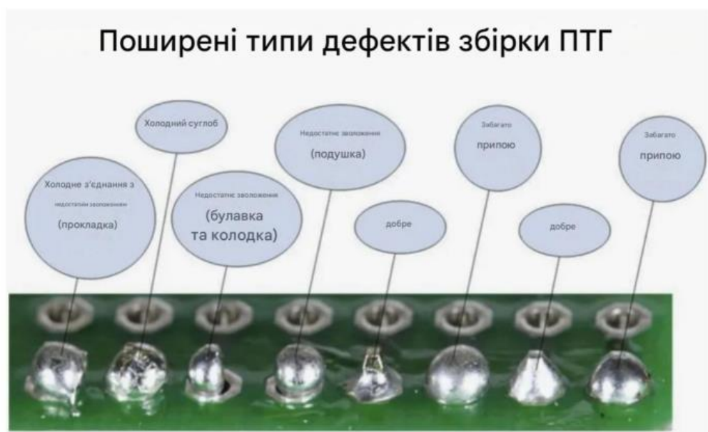
Рисунок 1.20 – Дефекти пайки друкованої плати
