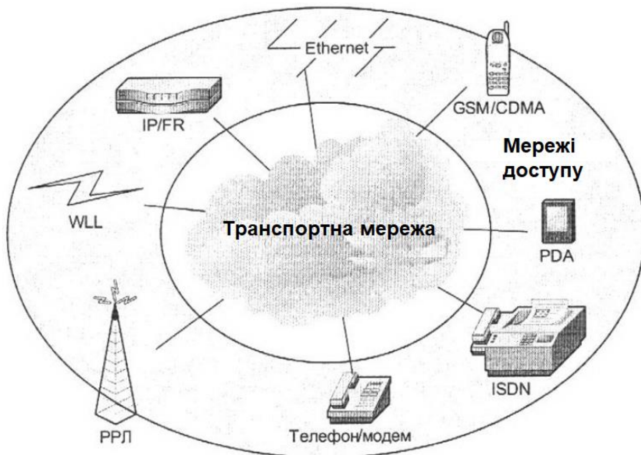
Рисунок 1.1 – Узагальнена фізична модель NGN за типом «транспортна мережа – мережі доступу»
