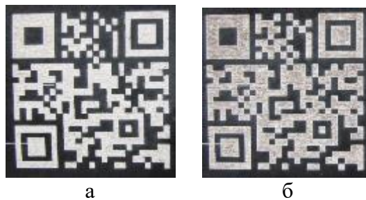
Рисунок 4 – Маркування чорного картону Arktika GC-2 потужністю 14 Вт (а) та 12 Вт (б) і швидкістю маркування 240 мм/с
