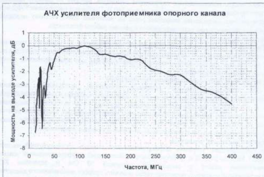
Рис. 4. Амплитудно-частотная характеристика электронной схемы усиления фотоприемника опорного канала.
