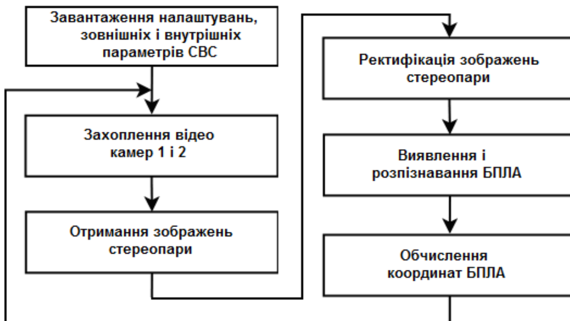
Рисунок 3.18 – Алгоритм обробки сигналів для визначення координат БПЛА
