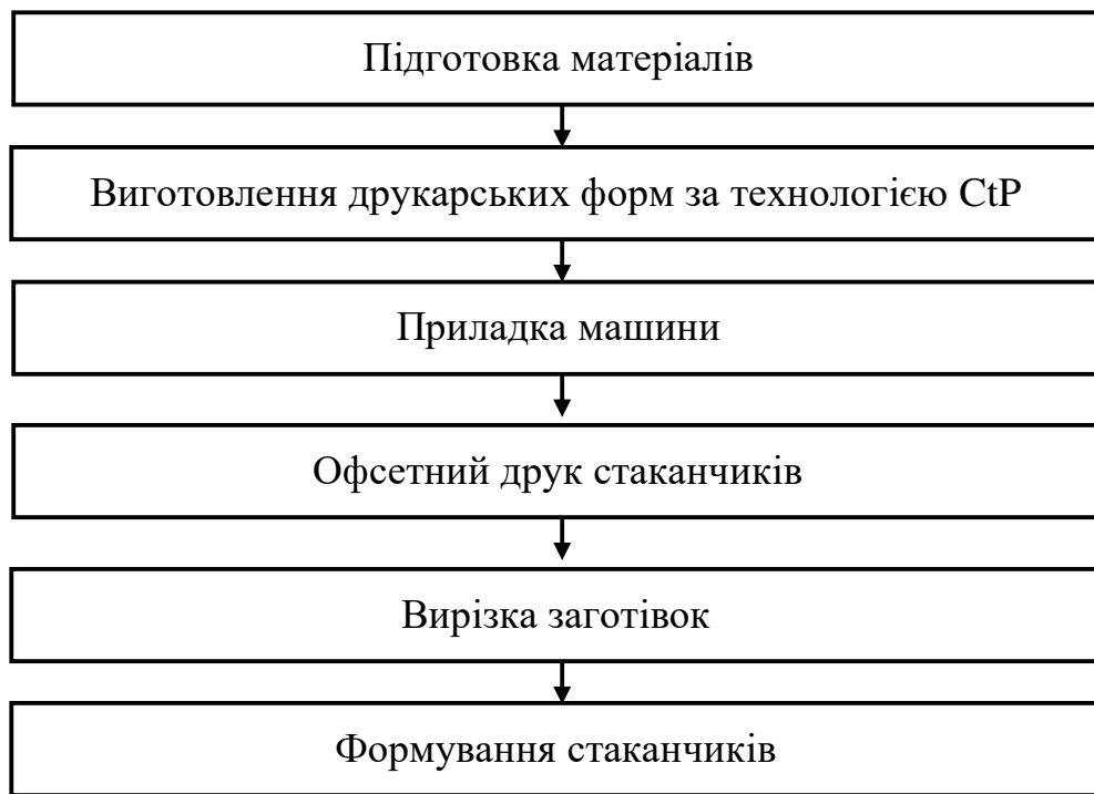
Рисунок 7.3 – Технологічна схема виготовлення стаканчиків
