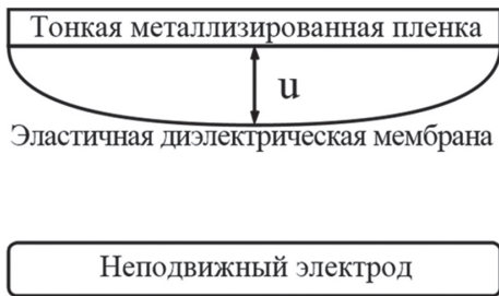
Рис. 1. Схема работы простейшей электростатической МЭМС
