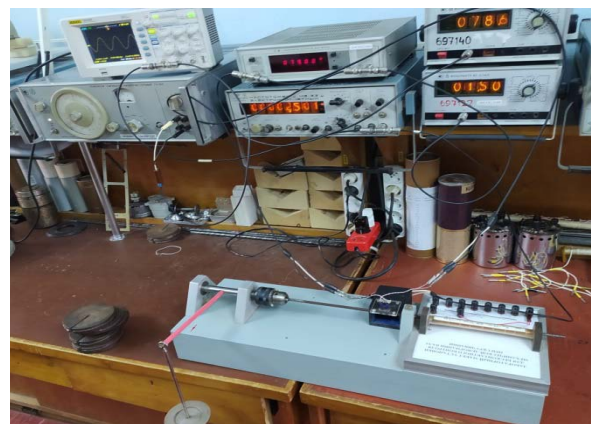
Рис. 2. Лабораторна установка для дослідження залежності вихідного сигналу диференціального ТЕМП накладного типу від величини механічного моменту скручування циліндричного феромагнітного виробу
