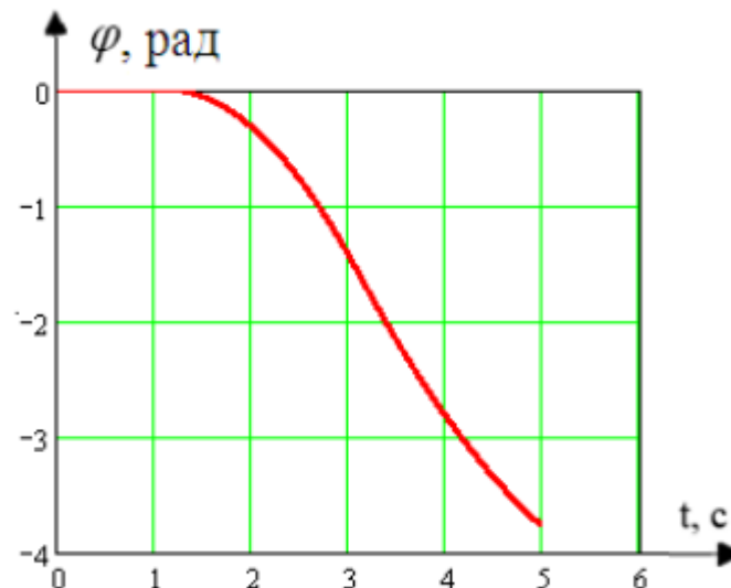
Рисунок 3.22 – Залежність кута повороту корпусу платформи від часу
