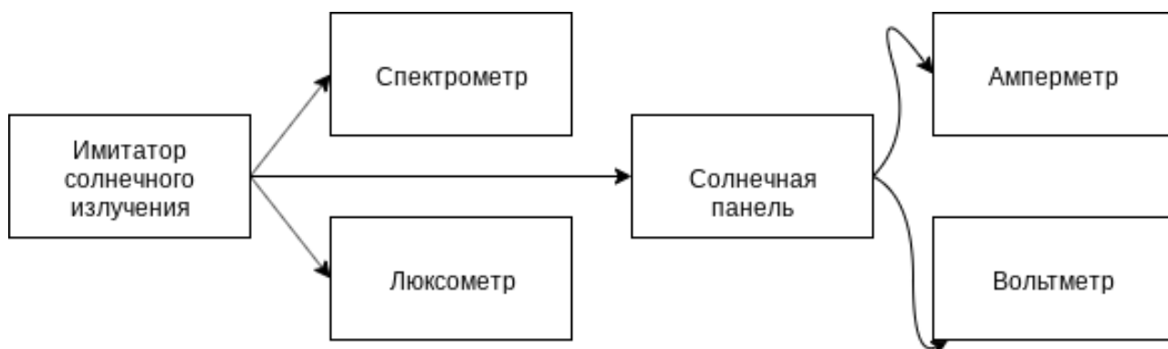
Рисунок 2.6 – Блок-схема експериментальної установки
