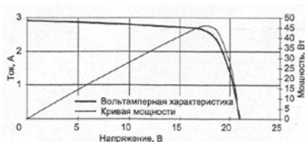
Рисунок 1.3 – Вольт-амперна характеристика сонячного елементу
