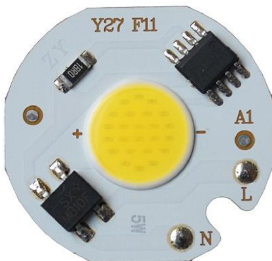
Рисунок 2.3 – Світлодіод повного спектра FT-MD-COB, 5W, 220V
