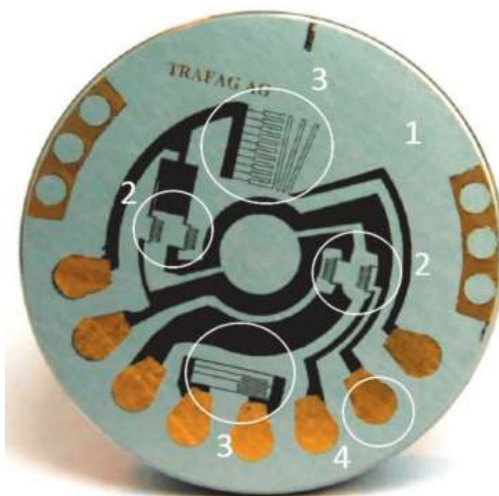
Рисунок 1.8 – Топологія чутливого елемента тензометричного сенсора
