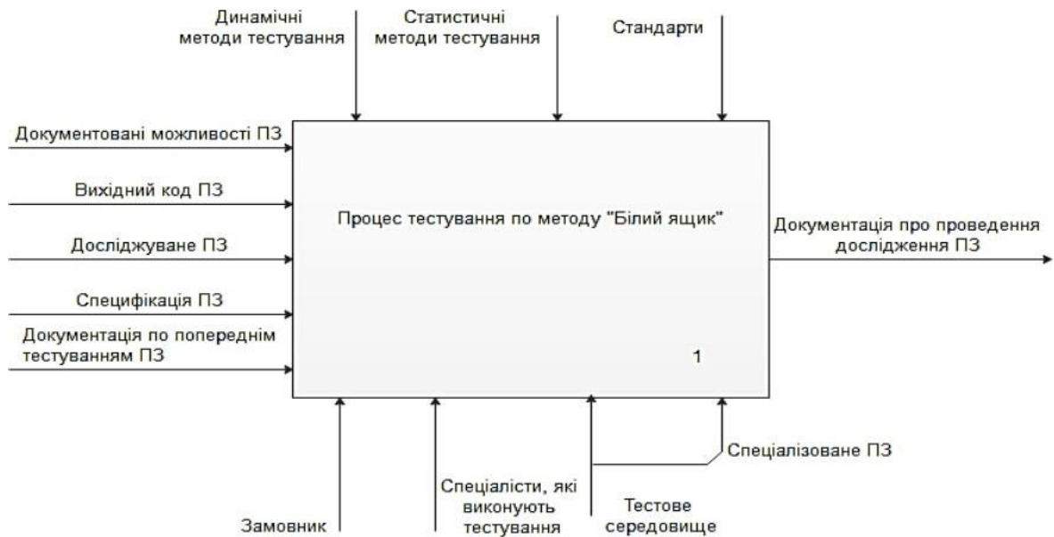
Рисунок 2.1 – Схема тестування методом «білого ящика»
