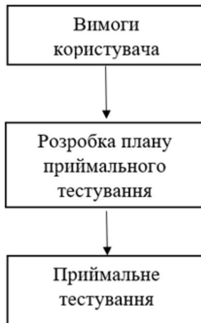
Рисунок 1.3 – Схема приймального тестування ПЗ
