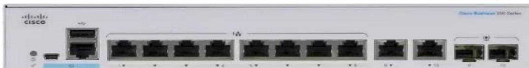
Рисунок 2.7 – Комутатор керований рівня 3 Cisco CBS350-8T-E-2G-EU
