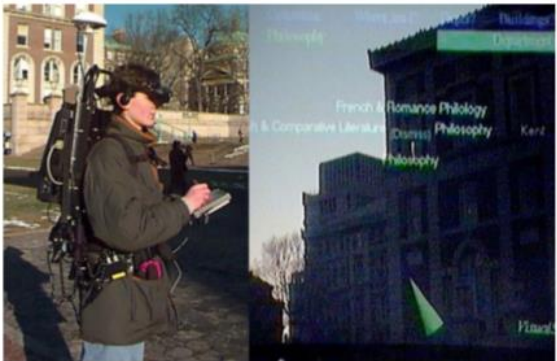
Рисунок 1.4 – Прототип однієї з перших мобільних систем доповненої реальності
