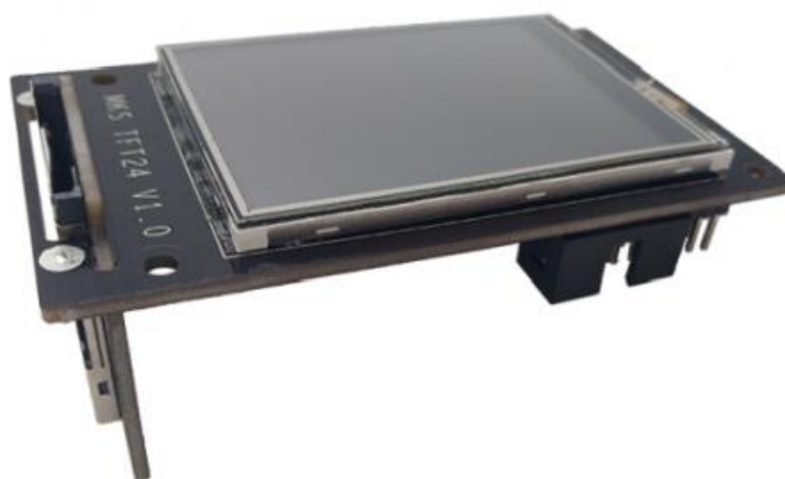
Рисунок 2.8 – Сенсорний дисплей MKS TFT24
