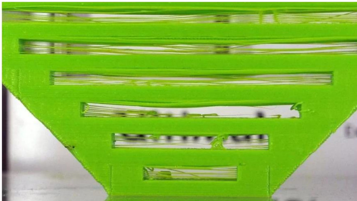
Рисунок 3.26 – Дефект друкованої деталі з мостом
