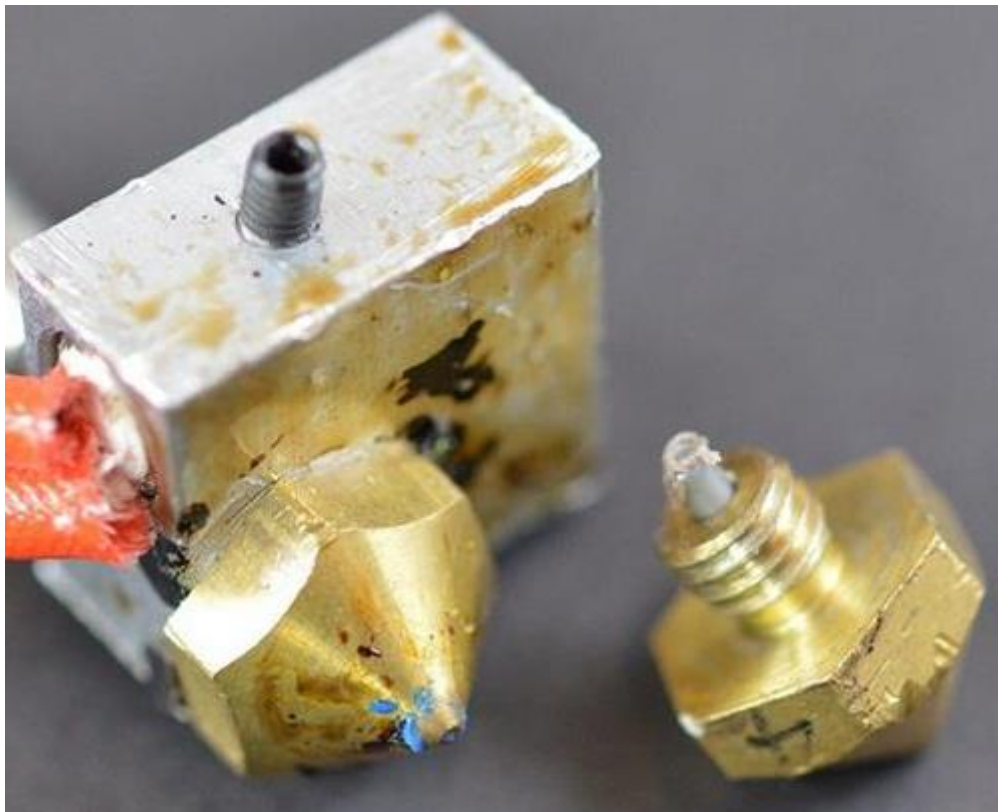
Рисунок 3.10 – Забите сопло екструдера
