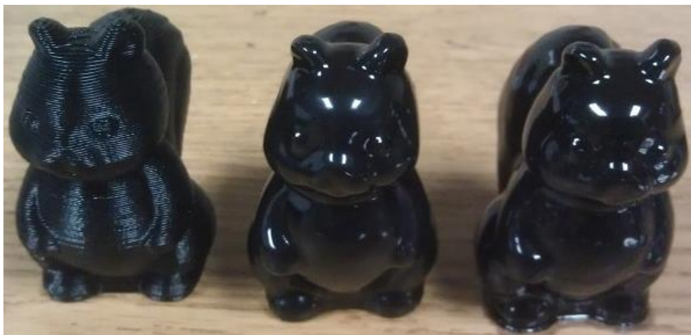
Рисунок 1.24 – Оброблені в ацетоні друковані моделі
