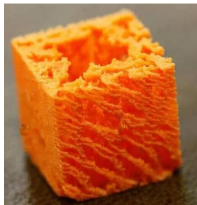
Рисунок 3.14 – Дефект створений недоекструзією пластика
