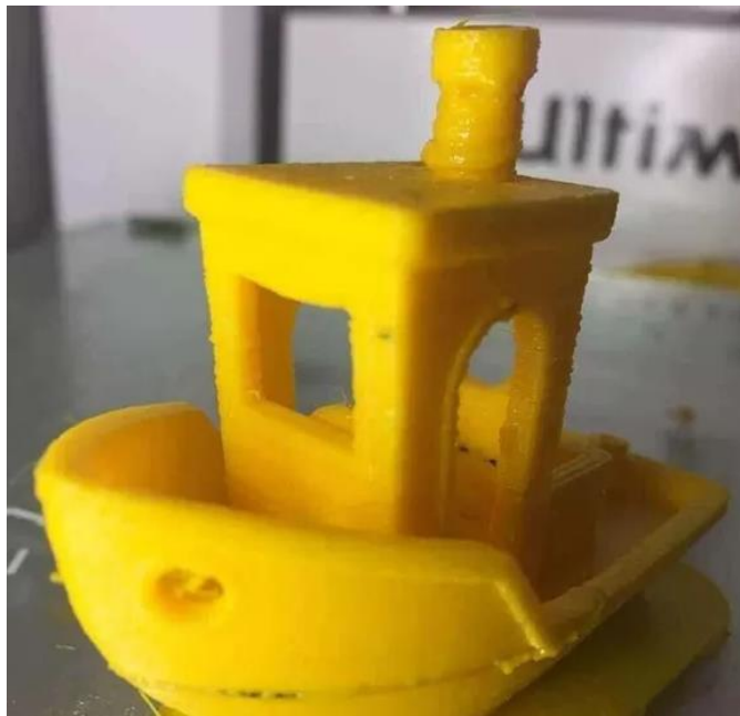
Рисунок 3.15 – Дефект оплавлення моделі
