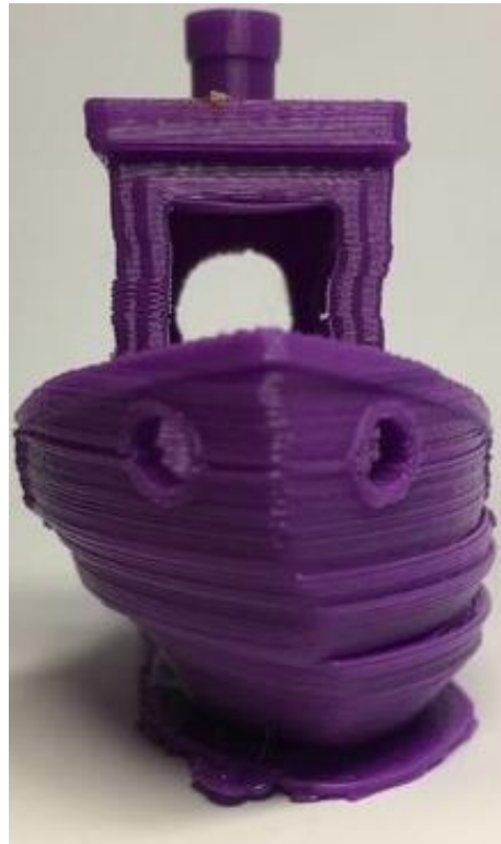
Рисунок 3.23 – Дефект зміщення шарів
