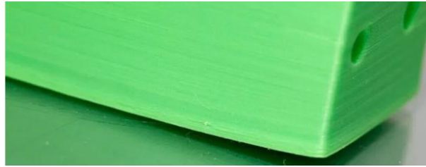
Рисунок 3.16 – Друкована модель з недостатньою температурою столу
