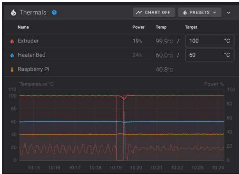
Рисунок 2.6 – Контроль температури у Klipper
