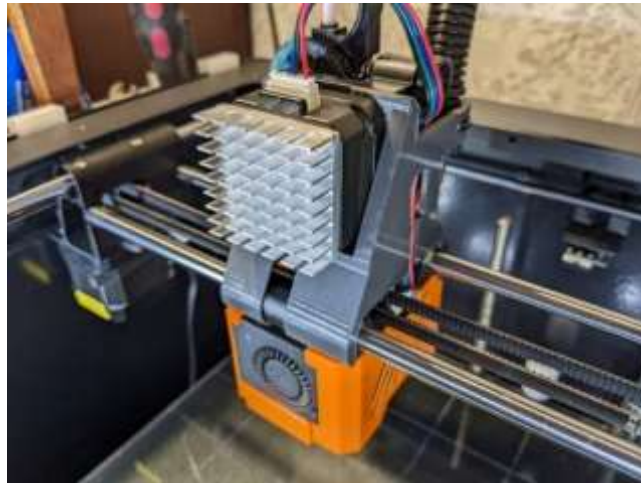
Рисунок 2.2 – Модифікація механізму подачі філаменту типу «Direct»
