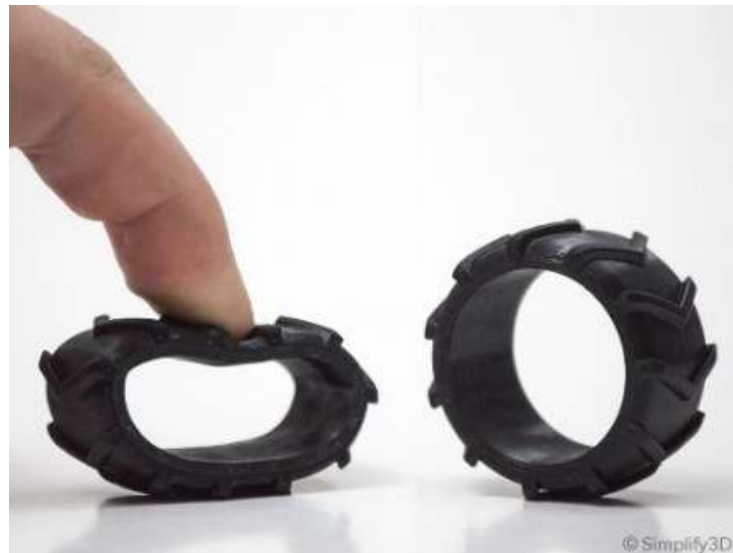
Рисунок 1.6 – Приклад друку з TPU/TPRE
