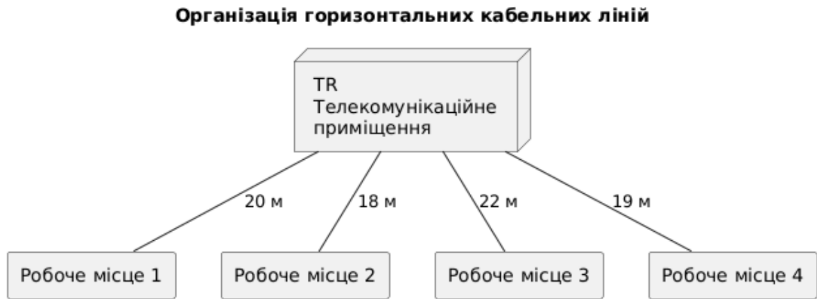
Рисунок 2.3 – Принцип організації горизонтальних кабельних ліній
