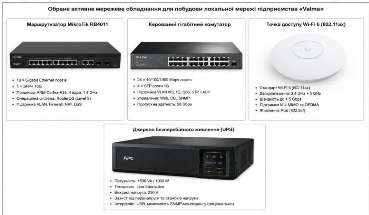
Рисунок 3.5 – Обране активне мережеве обладнання для побудови локальної мережі підприємства «Valma» (маршрутизатор MikroTik RB4011, керований гігабітний комутатор, точка доступу Wi-Fi 6 та джерело безперебійного живлення)
