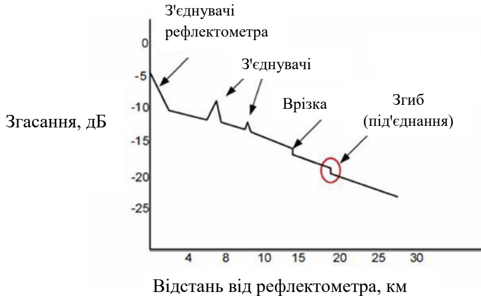
Рисунок 3.1 – Пошук підключення на оптичній трасі за допомогою оптичного рефлектометра
