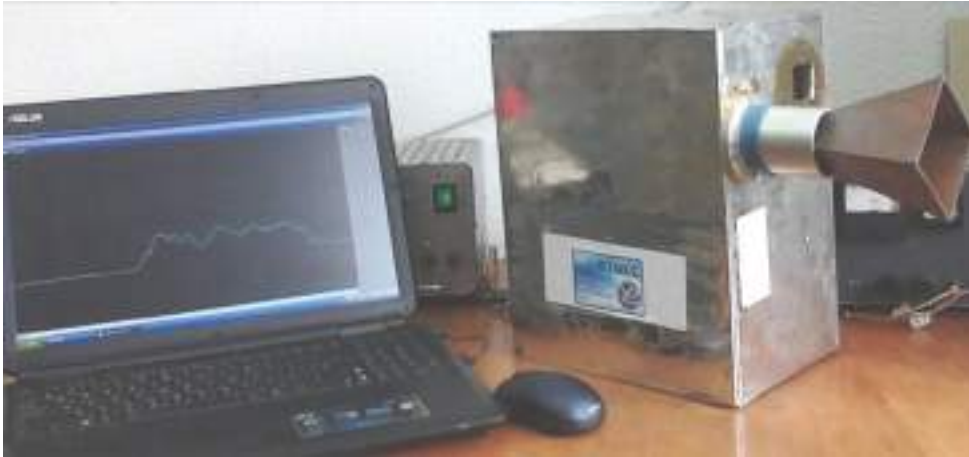
Рисунок 4.3 – Зовнішній вигляд радіометру діапазону 40 ГГц (8 мм) кафедри РТІКС ХНУРЕ
