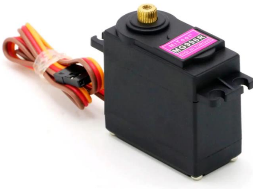
Рисунок 4.6 – Другий обраний сервопривід MG996R 360°
