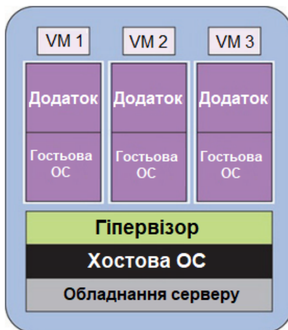
Рисунок 1.1 – Спрощене подання VM з гіпервізором 2-го типу
