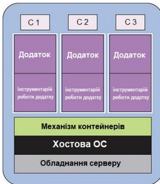
Рисунок 1.3 – Спрощене подання віртуального середовища на основі контейнерів
