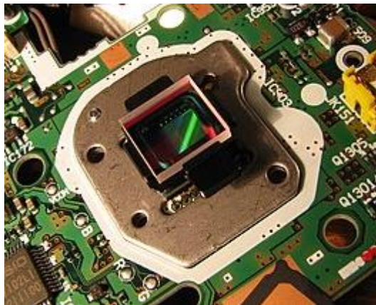
Рисунок 1.17 – Матриця на друкованій платі цифрового фотоапарата
