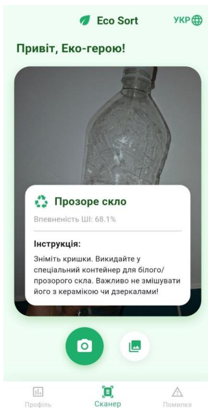
Рисунок 4.29 – Невдала класифікація предмету з відбивною поверхнею (прозорий пластик) за умов штучного освітлення
