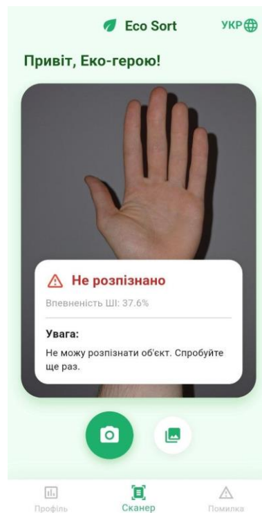
Рисунок 4.33 – Успішне спрацьовування механізму відхилення нецільових об'єктів (аномалій)
