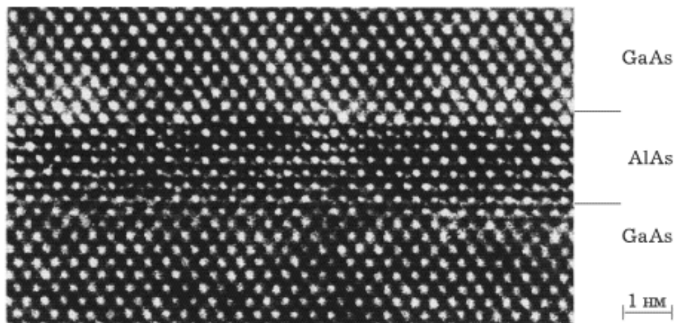
Рисунок 1.1 – Трансмісійний електронний мікроскоп свехрешетки GaAs / AlAs з високою роздільною здатністю. На мікрограмі показана для променя, падаючого в напрямку [110]
