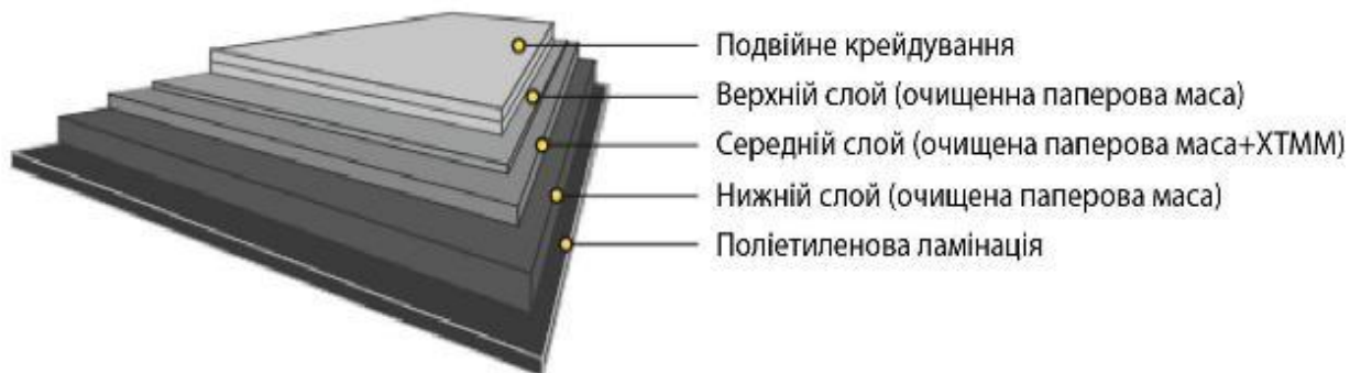
Рисунок 2.7 – Структура картону для стаканів Cupforma Special PE
