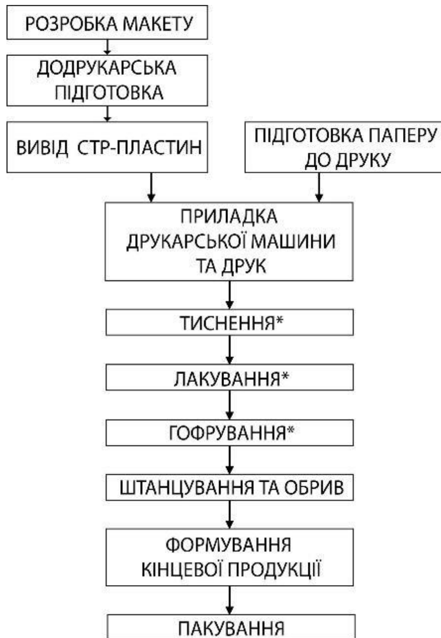
Рисунок 2.8 – Технологічний процес виготовлення паперового посуду
