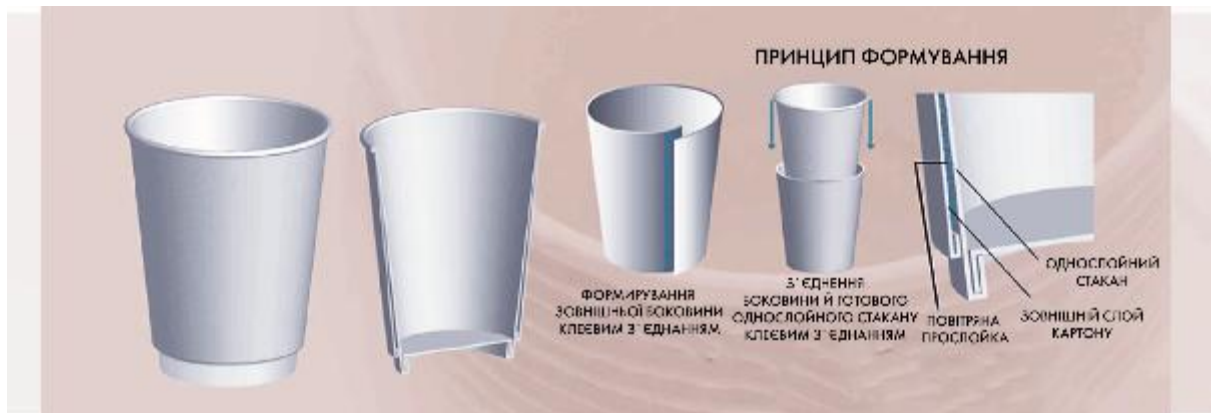
Рисунок 2.2 – Принцип формування двошарового стакану
