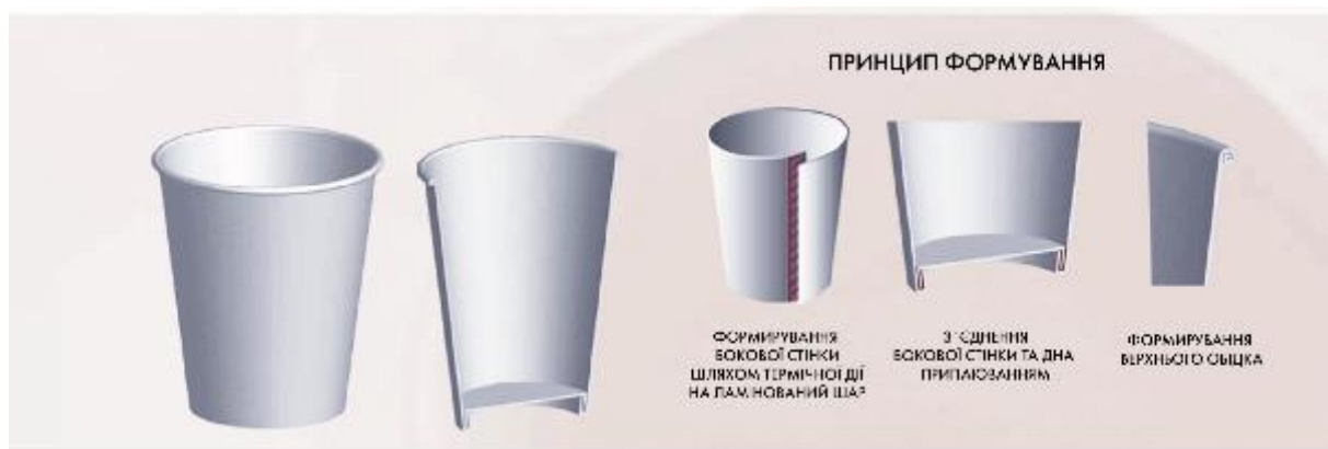
Рисунок 2.1 – Принцип формування одношарового стакану
