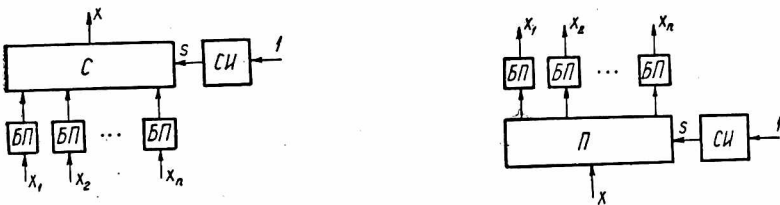
Рис. 4. Устройство, преобразующее запись слова из параллельной формы в последовательную
