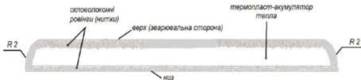
Рисунок 1.27 – Ескіз поперечного розрізу армованого термопласту
