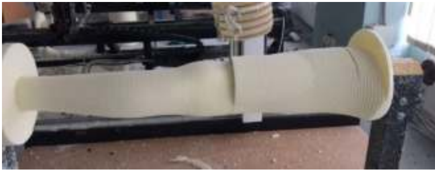
Рисунок 3.61 – Виготовлення моделі нижньої кінцівки з пінополіуретану на верстаті з ЧПУ
