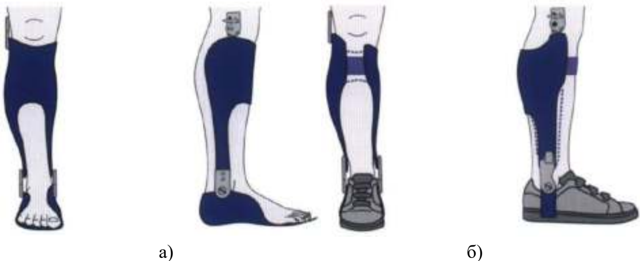
Рисунок 3.74 – Конструкції гільз у комбінації «гомілка-стопа» й «гомілка-взуття» з металевими гомілковостопними шарнірами: а – комбінація «гомілка-стопа»; б – комбінація «гомілка-взуття»
