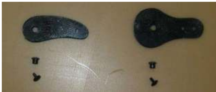
Рисунок 3.10 – Конструкції гомілковостопних (ліворуч) і колінних (праворуч) шарнірів із матеріалу «препрег»
