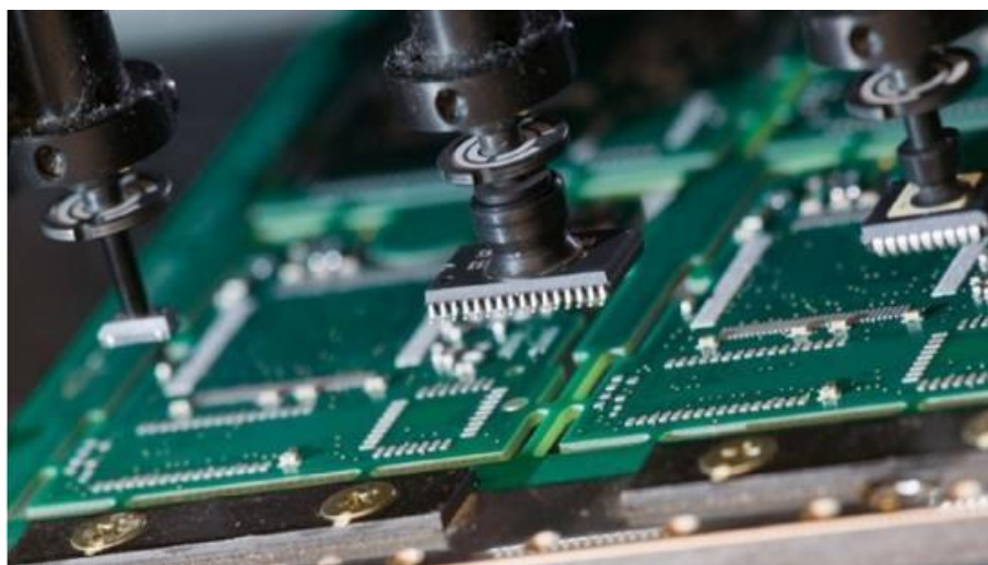
Рисунок 1.4 – Розміщення компонентів за допомогою машини Pick & Place [12]
