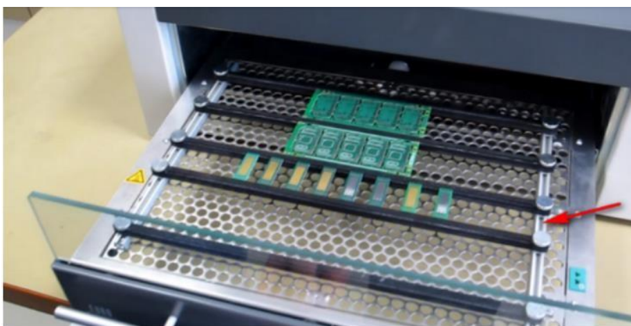
Рисунок 1.5 – Метод паяння оплавленням [13]
