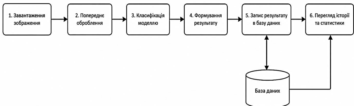
Рисунок 2.2 – Схема інформаційного потоку під час аналізу зображення
